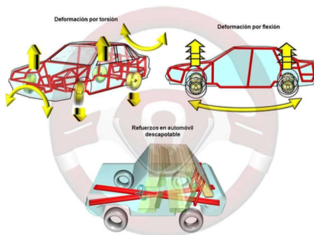
Figura 1. Torsión y flexión de la carrocería.
